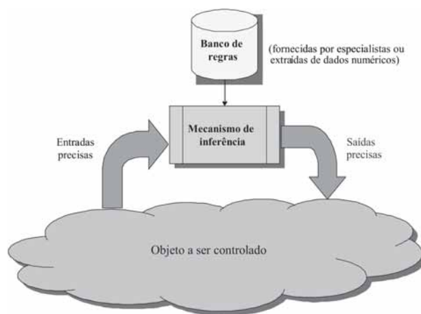
Figura 3 – Visão esquemática de um sistema de controle baseado em lógica clássica
