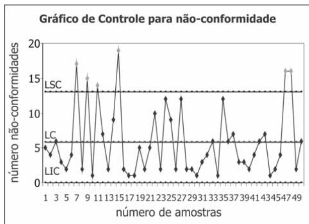
Figura 2 - Gráfico de controle para a média da variável das peças não-conformes Fonte: Gráfico CEP elaborado pelos autores da pesquisa (2009).
